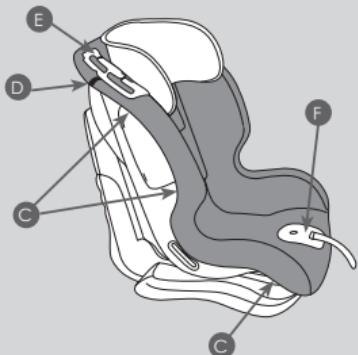
Husa principală este fixată de o serie de cârlige (C) situate pe spatele și dedesubtul carcasei. Desprindeți elasticul husei de pe cârlige. Desfaceți benzile Velcro® (D) de pe umerii carcasei, scoateți husa de sub cârligele centurilor (E), de după panoul ajustor din plastic (F) și de după elementul din plastic (G) și scoateți husa.
