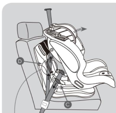
Βεβαιωθείτε ότι η ζώνη ασφαλείας του οχήματος δεν είναι στριμμένη και ότι είναι σωστά αγκιστρωμένη. Σπρώξτε το περιβλήμα του μικρού καθίσματος για μωρά για να εφαρμόσει καλά στο κάθισμα επιβάτη. Περάστε το οριζόντιο μέρος, κοιλιακή ζώνη, κάτω από τους γάντζους (C) και τεντώστε τη ζώνη, τραβώντας τη θωρακική ζώνη για να μειωθεί το παιχνίδι της. Περάστε τη θωρακική ζώνη, στη διάταξη μπλοκαρίσματος (D) "κλιπ μπλοκαρίσματος θωρακικής ζώνης" από την πλευρά της αγκιστρώσης της πόρτης οχήματος.
