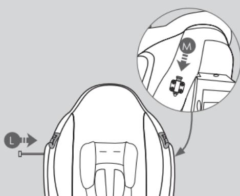
Riportare lo schienale della seduta in posizione originale. Inserire completamente la barra di fissaggio (L) e bloccarla dal lato opposto ruotando verso il basso il gancio (M) di bloccaggio barra schienale, fino ad udire lo scatto "click" che ne indica l'avvenuto bloccaggio. Verificare tirando la barra che questa non si sfilo e che sia correttamente montate e bloccate.
