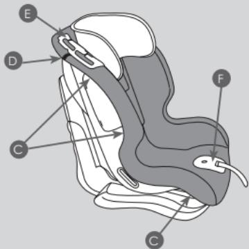
Il rivestimento è bloccato sulla scocca da una serie di ganci (C) posti nella parte posteriore e inferiore della scocca. Sganciare i ganci della copertura per rimuovere il rivestimento. Sganciare il velcro® (D).
