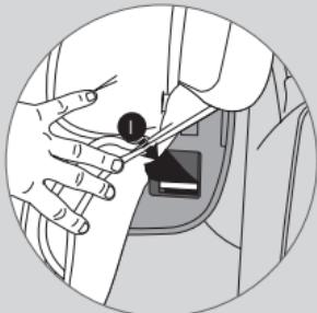
Compruebe que ninguna correa esté torcida; vuelva a conectar entre ellas las correas de los acolchados de las protecciones pectorales con el gancho (J) y pase los cinturones pectorales por el estribo metálico para tensar el cinturón (K).
