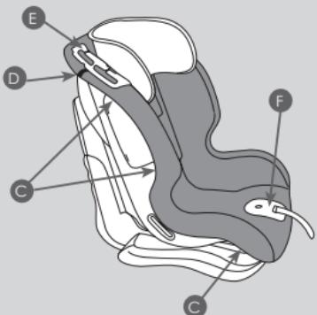
Desenganche los ganchos de la cubierta para quitar el revestimiento. Desenganche el velcro® (D). Para quitar el revestimiento de las guías del cinturón (E), tire ligeramente del tejido por debajo del gancho y suéltelo. Para quitar el tejido de la protección de, plástico (F), tire ligeramente del tejido por debajo de la protección de plástico y suéltelo.
