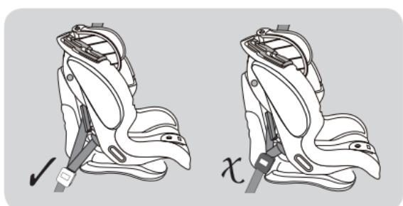
**OBSERVAȚIE:** Dacă aveți dificultăți când puneți la loc bara de instalare – mai întâi asigurați-vă că nu ați prins din greșeală centura diagonală, apoi scuturați ușor bara de instalare pentru a o ajuta să intre prin carcasa.
