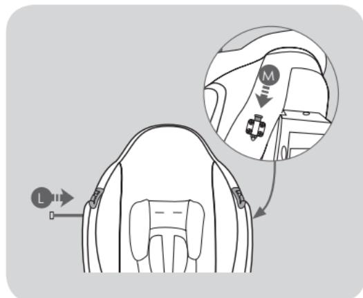
Ponga el respaldo del asiento en la posición de origen. Introduzca completamente la barra de fijación (L) y bloquéela por el lado opuesto girando hacia abajo el gancho (M) de bloqueo de la barra del respaldo, hasta que oiga el "clic" que indica que se ha bloqueado correctamente.
