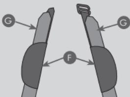
Inserir as correias das proteções peitorais e o cinto dos arneses nas respetivas aberturas (1) e (2). Levantar o revestimento do apoio de cabeça e inserir as correias das proteções e as correias dos arneses na abertura (I)
