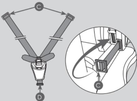
Certificar-se que estejam corretamente inseridos e bloqueados. Inserir o anel metálico do cinto inguinal, através da abertura da almofada, do revestimento e através da abertura na armação (3). Certificar-se que estejam corretamente inserido e bloqueado.
