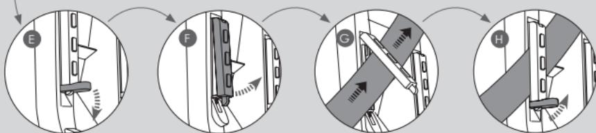
Για να μπλοκάρετε τη θωρακική ζώνη με τη διάταξη "κλιπ μπλοκαρίσματος θωρακικής ζώνης" προχωρήστε ως εξής: Κατεβάστε το κουμπί (E) και ανασηκώστε το κλιπ διακοπής (F). Περάστε τη θωρακική ζώνη κάτω από το κλιπ διακοπής και τεντώστε τη θωρακική ζώνη για να εξαλείψετε ενδεχόμενα παιχνίδια. Κατεβάστε το κλιπ (G) και ανασηκώστε το κουμπί (H). Για να διευκολύνετε το κλείσιμο, πατήστε το κλιπ διακοπής και ανασηκώστε το κουμπί. Βεβαιωθείτε για το σωστό μπλοκάρισμα.
