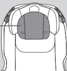
Remover o apoio de cabeça, soltando as duas linguetas Velcro® de cada um dos lados na parte traseira do apoio de cabeça (I).
