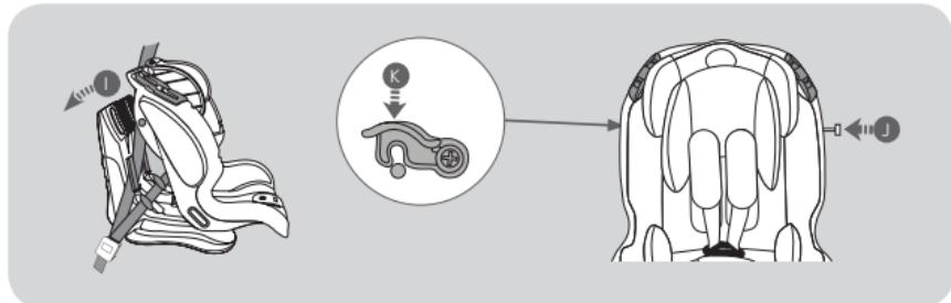
Reduceti carcasa in pozitia initiala (I) (avand grija sa nu prindesti centura diagonală de umăr) și reintroduceți bara de instalare prin scaun (J). Securizați opritorul din partea dreaptă sus a scaunului auto (K). Trageți de bara de instalare pentru a vă asigura că este bine fixată în poziție.
