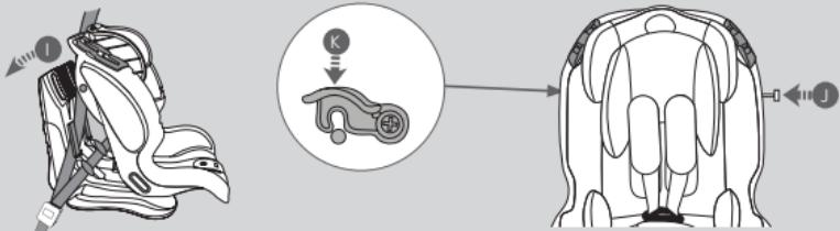
Recolocar o encosto do assento na posição original (I). Prestando atenção para não bloquear o cinto peitoral. Inserir completamente a barra de fixação (J) e bloqueá-la no lado oposto rodando para baixo o gancho de bloqueio da barra de encosto, até ouvir um "clique" que indicará o seu bloqueio (K). Verificar, puxando a barra, que esta não saia e que esteja corretamente montada e bloqueada.
