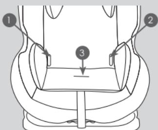
Introduceți cataramele bretelelor centurii (C) prin cele două orificii (1) și (2) de pe husă și apoi în afară prin orificiile exterioare de pe spatele carcasei, apoi înapoi prin orificiile interioare.
