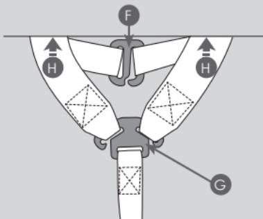
Desenganche las correas del arnés por la parte trasera del respaldo, soltando las correas de las protecciones pectorales del gancho (F) y soltando los dos cinturones pectorales del estribo de tensado del cinturón (G). Pase el cinturón a través de las ranuras presentes en la parte trasera del bastidor (H).
