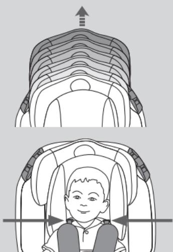
Πυθμίστε το υποστήριγμα κεφαλής και τις τιράντες τραβώντας τη λαβή που βρίσκεται στο πίσω μέρος του υποστηρίγματος κεφαλής. Σηκώστε ή κατεβάστε το υποστήριγμα κεφαλής ανάλογα με το ύψος του μωρού.
