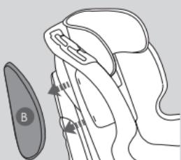
Remover as almofadas de proteção lateral (B) puxando em direção das setas, para libertá-las da armação e remover então o revestimento das proteções.
