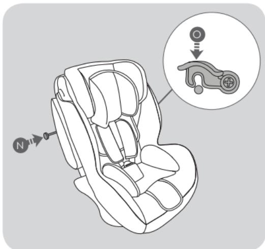
Reduceti carcasa in pozitia initiala si reintroduceti bara de instalare (N) si securizati opritorul (O).
