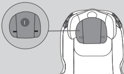
Quite el reposacabezas, desenganchando las dos lengüetas Velcro® por cada lado de la parte trasera del reposacabezas (I).
