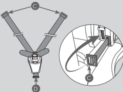
Introduzca el anillo metálico del cinturón de entrepierna, a través de la guía del cojín, del revestimiento y a través de la ranura del bastidor (3). Asegúrese de que está bien colocado y bloqueado.
