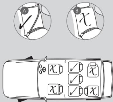
La sillita se puede utilizar solo con cinturones de seguridad de 3 puntos (A) y NO con cinturones de seguridad de 2 puntos (B). La sillita debe instalarse orientada hacia delante en los asientos traseros del vehículo, utilizando los cinturones de 3 puntos del vehículo, para la fijación. Si la sillita no está bien fijada en un asiento de pasajeros, le aconsejamos que pruebe a instalarla en otro asiento del vehículo.
