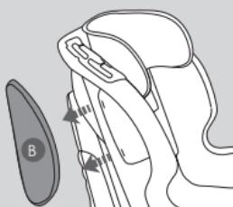
Trageți de cele două sisteme de Protecție Armată Laterală (SAP) (B) în direcția săgeților pentru a le desprinde de pe carcăsa și a le scoate husele.
