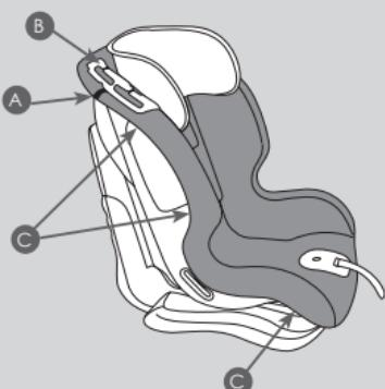
O revestimento tem um impacto direto no funcionamento do dispositivo de retenção em termos de segurança. Nunca utilizar a cadeira de automóvel sem revestimento.
