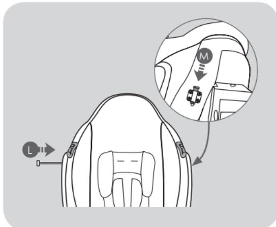
Reduceti carcasa in pozitia initiala si reintroduceti bara de instalare (L) si securizați opritorul (M).
