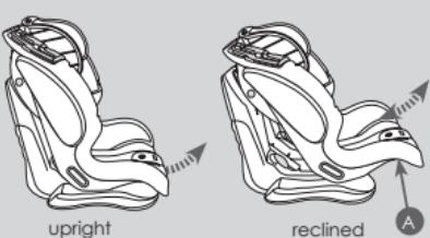
Scaunul auto poate fi folosit în patru poziții diferite, de la poziția așezat până la poziția rabatit complet pentru somn. Trageți de mânerul de reglare a rabatării (A) situat dedesubtul carcasei în partea din față și trageți carcasa spre înainte sau spre spate, eliberați mânerul atunci când scaunul se află în poziția dorită și auziți un click.
