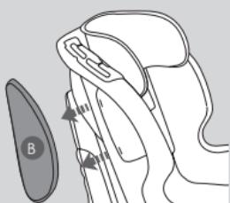
Rimuovere i cuscini di protezione laterale (B) tirando in direzione delle frecce, per sganciarli dalla scocca e rimuovere poi il rivestimento dalle protezioni.
