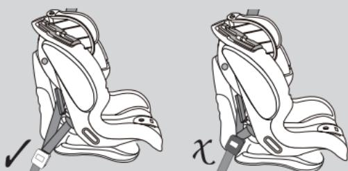
**NOTAS:** Si tiene problemas para introducir la barra, asegúrese antes de que el cinturón pectoral no impida que el respaldo se recline en la posición de origen; después intente mover ligeramente la barra mientras la introduce, para facilitar de esta manera la introducción en el bastidor.
