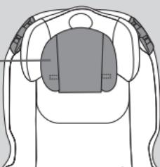
Desfaceți cele două sisteme de prindere din velcro de la spatele pernitei pentru cap (I) și îndepărtați-o.
