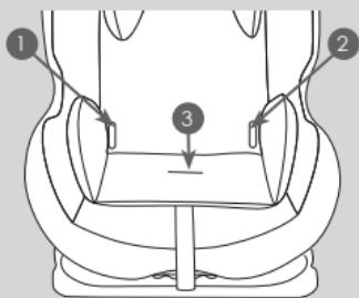
Introduzca los anillos metálicos (C) de la parte abdominal del cinturón en las guías (1) y (2) del revestimiento y a través de las ranuras externas en el bastidor. Introduzca por la parte trasera del bastidor, los anillos metálicos (C) a través de las ranuras internas.
