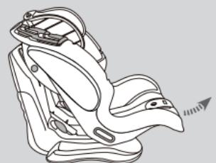
Gire hacia arriba el gancho de bloqueo de la barra del respaldo (D) situada al lado del asiento y deslice por el lado opuesto la barra de fijación (E) hacia fuera.
