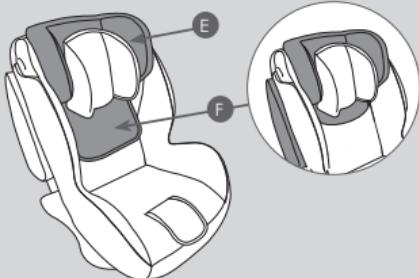
Acople el revestimiento al cojín de protección lateral (D), y siguiendo las direcciones de las flechas de la figura, enganche el cojín al bastidor. Asegúrese del enganche correcto. Repita la operación con el segundo cojín de protección lateral. Vuelva a poner el revestimiento (E) en el reposacabezas, introduzca la parte inferior del revestimiento (F) por detrás del revestimiento principal de la sillita.
