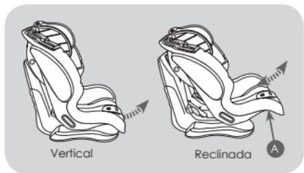
La sillita puede abatirse en 4 posiciones diferentes, desde la posición vertical a la posición más reclinada. Presione la manija de regulación situada debajo de la parte frontal del asiento de la sillita y, manteniéndola presionada, tire o empuje el asiento hacia delante o hacia atrás. Suelte la manija en la posición deseada y asegúrese de que el asiento
