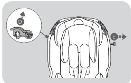
Rodar para cima o gancho de bloqueio da barra de encosto (D) ao lado do assento e remover pelo lado oposto a barra de fixação (E) para o exterior.
