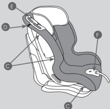
O revestimento está bloqueado na armação por uma série de ganchos (C) colocados na parte traseira e inferior da armação. Soltar os ganchos da cobertura para remover o revestimento. Soltar o velcro® (D). Para remover o revestimento dos passantes guia do cinto (E) puxar ligeiramente o tecido de debaixo do gancho e retirá-lo. Para remover o tecido da proteção em plástico (F) puxar ligeiramente o tecido dedebaixo da proteção em plástico e retirá-lo.
