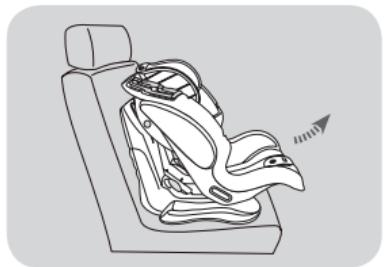
Coloque la sillita en el asiento del pasajero. Regule la sillita en la posición más reclinada. Presione la manija de regulación situada bajo la parte frontal del asiento de la sillita y, manteniéndola presionada, tire hacia arriba el asiento hasta la posición más reclinada. Suelte la manija.
