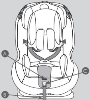
**IMPORTANTE:** No tire del cinturón sujetando los acolchados de protección pectoral.
