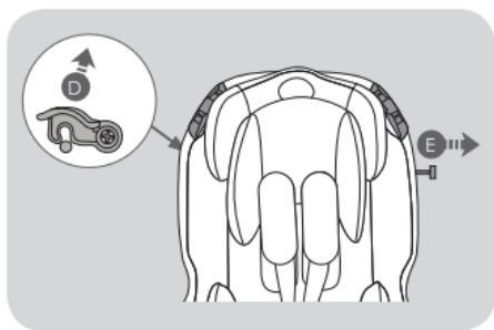
Eliberați blocajul (D) din partea stângă sus a carcasei și scoateți bara de instalare (E).
