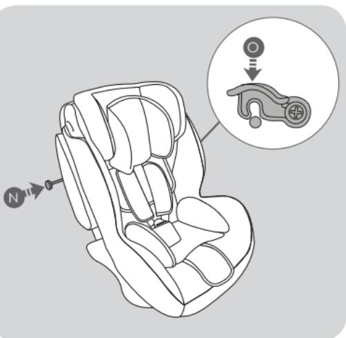
Recolocar o encosto do assento em posição original. Inserir completamente a barra de fixação (N) e bloqueá-lo pelo lado oposto rodando para baixo o gancho de bloqueio da barra de encosto, até ouvir um "clique" que indica o seu bloqueio (O). Verificar puxando a barra que esta não saia e que esteja corretamente montada e bloqueada.
