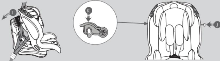
Sitúe el respaldo del asiento en la posición de origen (I). Procure no bloquear el cinturón pectoral. Introduzca completamente la barra de fijación (J) y bloquéela por el lado opuesto, girando hacia abajo el gancho de bloqueo de la barra del respaldo, hasta que note el "clic" que indica que se ha bloqueado (K). Compruebe, tirando de la barra, que ésta no se mueva y que esté bien montada y bloqueada.
