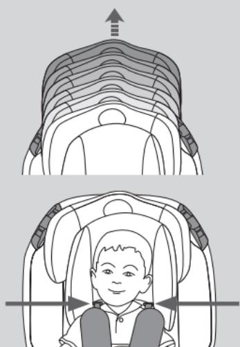
Regular o apoio da cabeça e os arneses, puxando o manípulo colocado na parte traseira do apoio de cabeça. Levantar ou abaixar o apoio da cabeça conforme a altura da criança.
