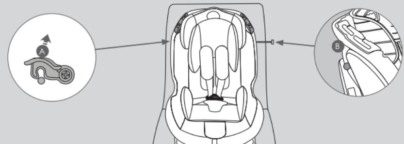
Eliberați blocajul (A) din partea stângă sus a carcasei și scoateți bara de instalare (B).
